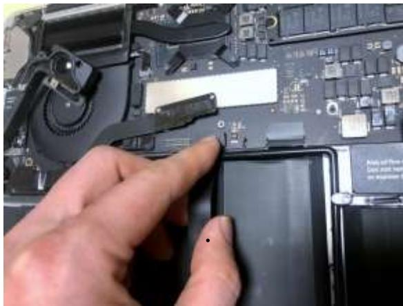
**手順 10-1 :** コントロールパッドのケーブルを取り付けて下さい。
