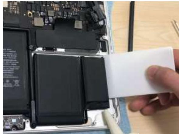
**手順 7-1 :**ヘラとアルコールを使って、バッテリーを剥がして下さい。(外側のバッテリーから外していくます) 純正のバッテリーは、かなり強めに接着されている場合もありますので、以降の手順も見ながら慎重に作業して下さい
