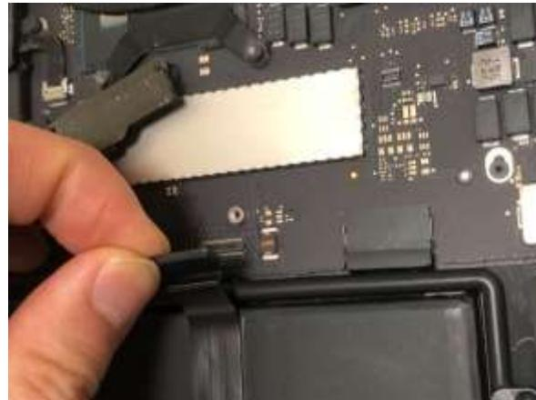
**手順 6-3 :**コントロールパッドのケーブルポートを取り外して下さい。スキッドを使用することができます。
