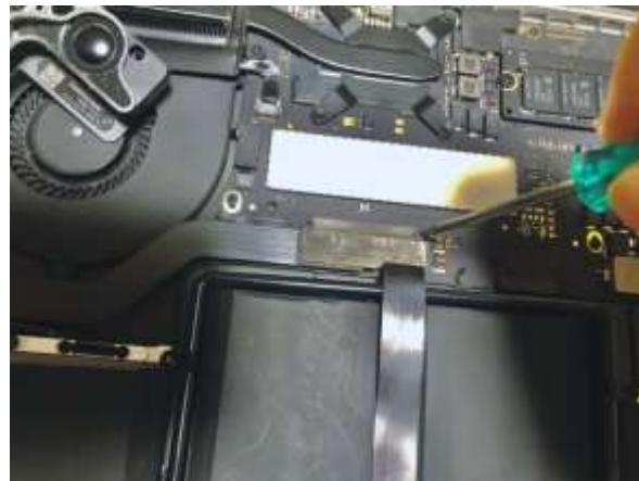
**手順 11-2 :** 保護カバーを取り付け、ケーブルポートのネジを締めて下さい。(二カ所)、
