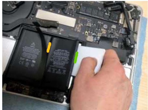
**手順 7-3 :**両側の四つのバッテリーを剥がせたら、最後に真ん中の二つのバッテリーを剥がします。図ではバッテリーの外側から（緑色）剥がしていますが、真ん中（オレンジ色）にヘラを食い込ませて外すことも可能です。
