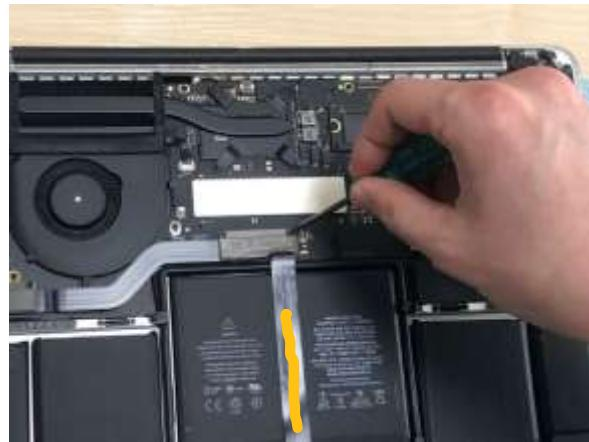
**手順 6 :**六つ星ドライバーで、ネジコントロールボードのケーブルポートのネジを外して下さい。(二カ所) 外したら、そのまま保護カバーも外して下さい。※モデルによっては、バッテリー中央部に被さっているケーブルがありません(オレンジ線)。その場合は、この手順6はスキップして下さい。
