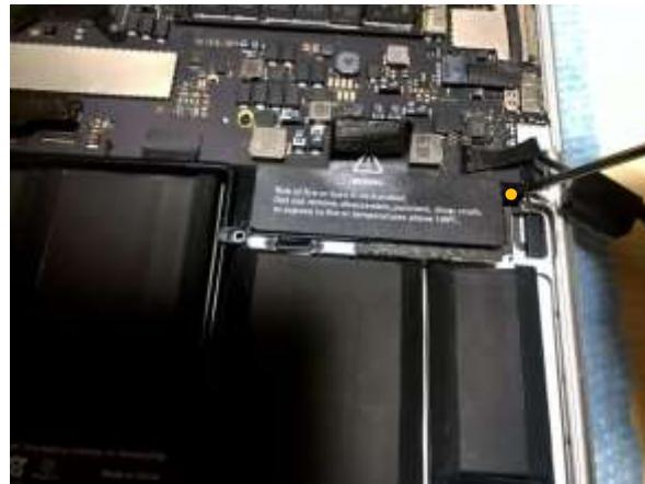
**手順 10 :** ここからは、これまでの手順の逆戻りをしていきます。まず、バッテリー回路基板のネジを取り付けて下さい。(オレンジ)
