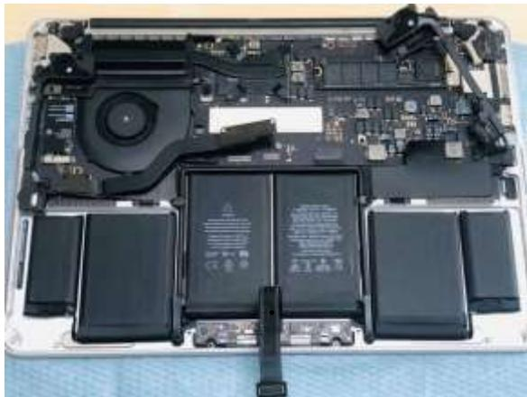
**手順 6-4 :**コントロールパッドのケーブルを剥がし、反対方向に置いて下さい。
