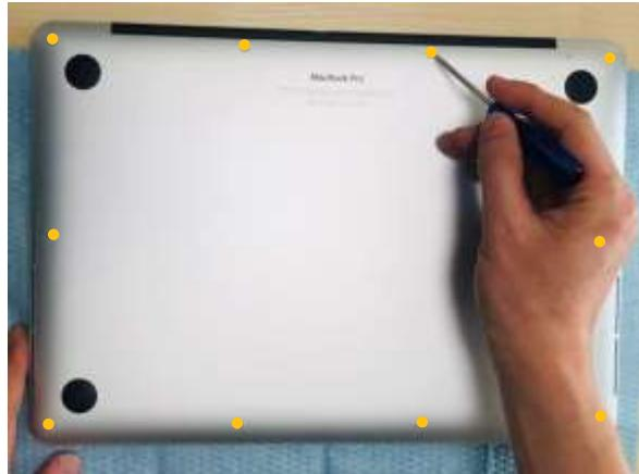
**手順 2-1 :** 5つ星ドライバーで、背面カバーのネジを全て取り外します。(計 10 カ所)
