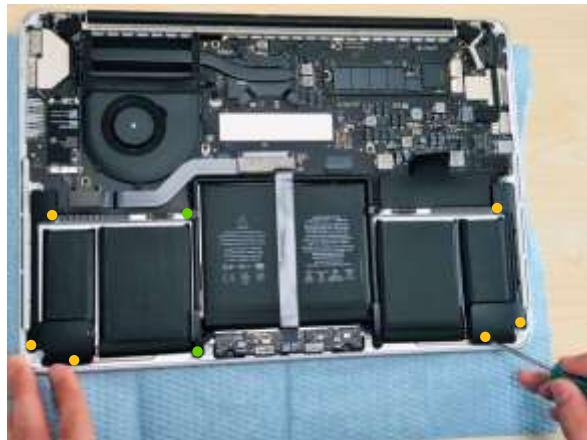
**手順 5 :** 左右に取り付けられているスピーカーネジを外して下さい。合計六ヶ所ありますが、箇所によってネジのサイズが異なりますので、外したネジを置く際にメモをしておくことをお勧めします。※2013, 2014 年モデルの場合、緑の○付近のネジも外して下さい。
