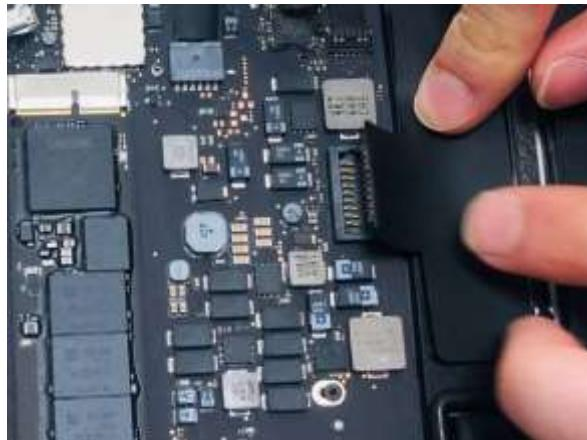
**手順 3 :** バッテリーとパソコンを接続しているバッテリーポートを外してください。力を入れ過ぎないで、丁寧に上に引き上げるイメージです。⇒[動画で確認する](#)
