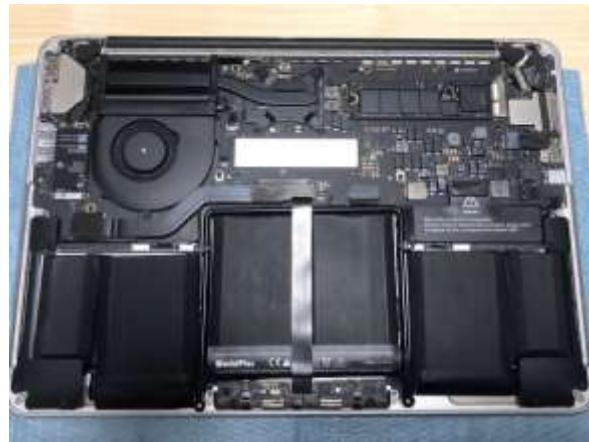
**手順 13-2 :** 一通りの取付が完了し、バッテリーが正確な位置に収まったことを確認できたら、手でバッテリーを丁寧に下に押し込んで、接着部がしっかりと接着するようにして下さい。
