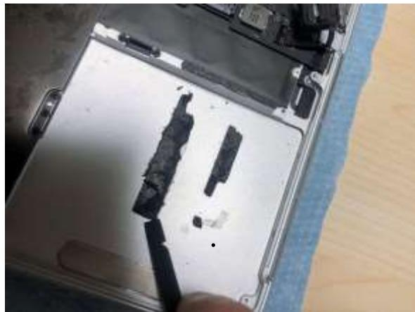
**手順 8-1 :**バッテリーを取り外した後、接着物質が残りますので、スキッドと指を使って全て取り除いて下さい。
