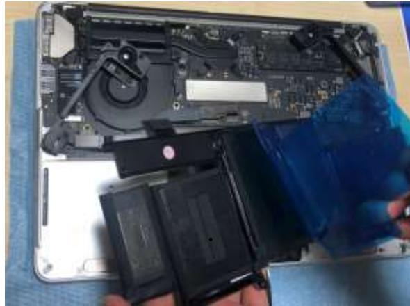
**手順 9-1 :**新品のバッテリーをご確認下さい。背面の保護シートを取り外して、パソコンに取り付けて下さい。位置が正確になるよう、バッテリーの端とパソコンの取付部の端が合うよう、丁寧に取り付けて下さい。
