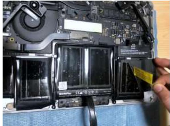
**手順 9-2 :**正確な位置に取り付けたら、表面のフィルムを取り外して下さい。
