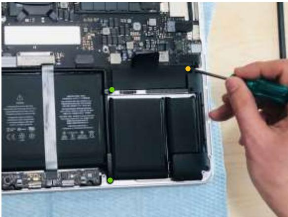
**手順 4 :** 六つ星ドライバーで、バッテリー回路基板のネジを外してください。※2013, 2014 年モデルの場合、緑の○付近にも外す必要のあるネジがあります。
