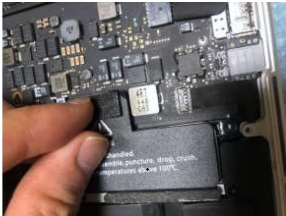
**手順 13 :** バッテリーとパソコンを接続しているバッテリーポートを付けて下さい。丁寧に行って下さい。(手順 3 を参考) **※正しく接続されていないと、パソコンがバッテリーを認識できないトラブルが発生しますので、その点を踏まえ、丁寧に正しく取り付けて下さい。**
