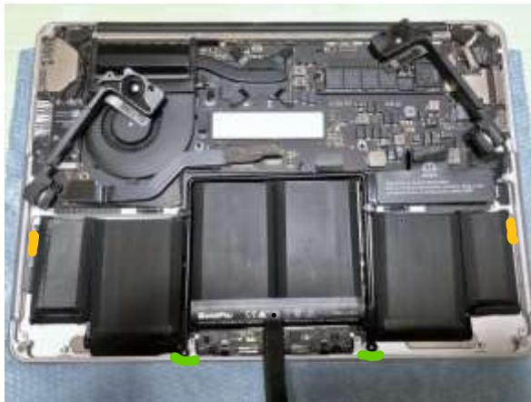
**手順 9-3 :** 新品のバッテリーが正しい位置に収まったことを確認します。見るポイントの参考として、オレンジ色部分にはスピーカーが收まりますので、ある程度の間隔がある必要があります。緑色部分は、シルバーのアルミ部分の形状にフィットしている必要があります。
