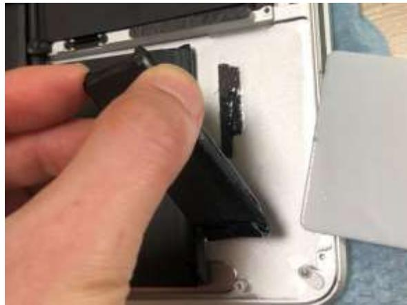
**手順 7-2 :**コツとしては、接着部にアルコールを流した後、ヘラを接着部にセットし、バッテリーの下側に滑り込ませるような方向で、ヘラを左右に振りながら力をぐいぐい入れていきます。力の入れ方と方向が掴めれば、比較的短時間で取り外すことができるはずです。[⇒動画で確認する](#)
